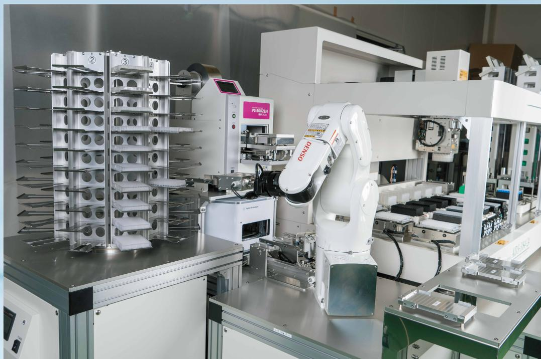
ADSで分注作業を行ったのち、ロボットでプレートを別の機器へ移動させそこで作業
